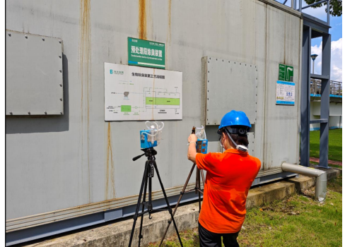
采样地点: 预处理段除臭装置巡检点, 噪声、硫化氢、氨
