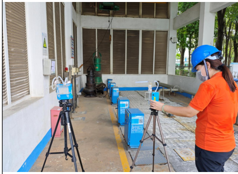
采样地点: 提升泵房巡检点, 噪声、硫化氢、氨
