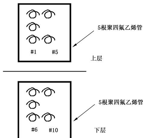
图 4 于灭菌器上下两层摆放方式
