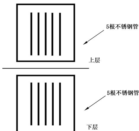
图 2 于灭菌器上下两层摆放方式
